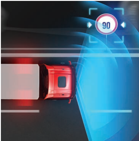
ISA - TRAFFIC SIGN RECOGNITION Erkennt Geschwindigkeitsbegrenzungen mittels Kamera- und Navigationsdaten, warnt bei Verstößen und greift gegebenenfalls ein.
